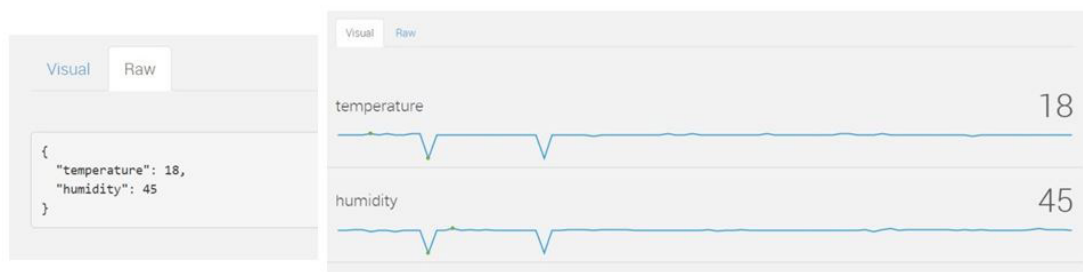
Figura 3. Telas da plataforma Dweet io com exemplos de um canal transmitindo dados sobre temperatura e umidade em duas modalidades de visualização
